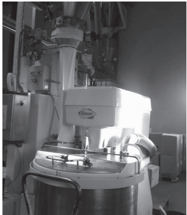
Figuur 6 Stortpunt en kneder met afzuiging (nieuwe situatie)
