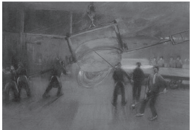
Het keren van een met gloeiend staal gevulde gietpot
