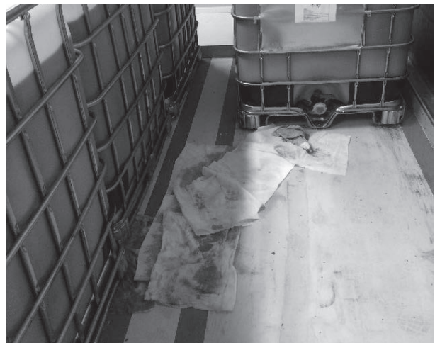
Figuur 6 Cubitainer met een lekkende sluiting
